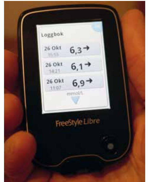
På avläsaren ser han sina blodsockervärden. Pilen efter värdet visar att värdet är stabilt. Hade pilen pekat upp eller ner hade det tytt på att blodsockret var på väg upp respektive ner.
